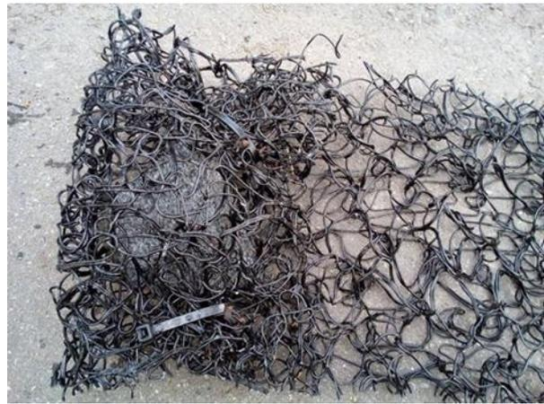
Stein zum Beschweren der Ausstiegshilfe mit Kunststoff Kabelbinder fixieren. Überstehende Enden abschneiden
