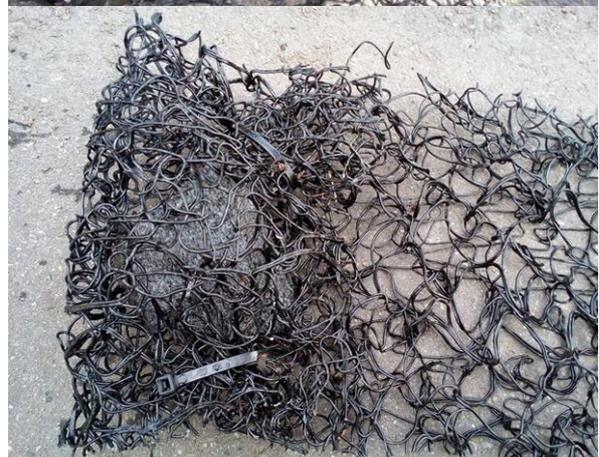
Zum beschweren Stein mit Kunststoffkabelbinder ans untere Ende einbinden.
